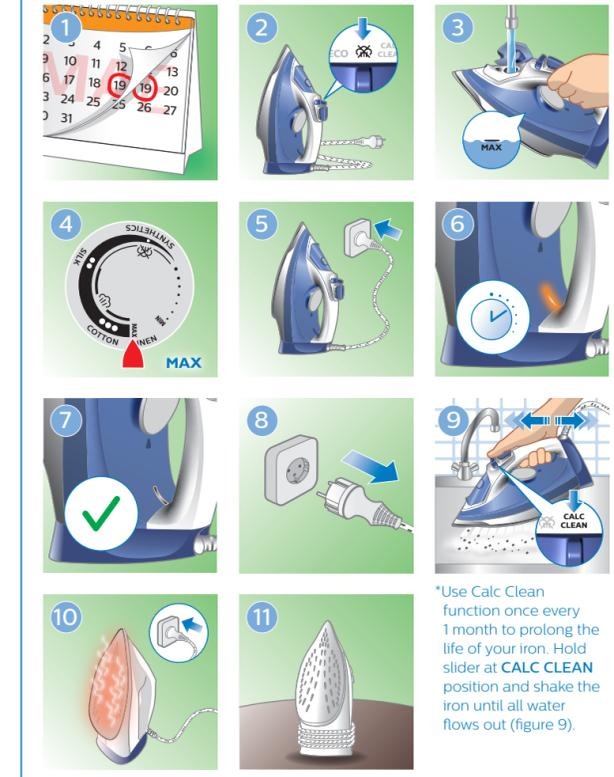
**DE** Verwenden Sie die Calc-Clean-Funktion jeden Monat, um die Lebensdauer Ihres Bügeleisens zu verlängern. Halten Sie den Schieberegler auf der Position "CALC CLEAN", und schüttele Sie das Bügeleisen solange, bis das ganze Wasser herausgelaufen ist (Abbildung 9).
